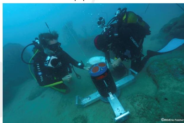
Figure 6 : Déploiement de l'ADCP, équipement financé par le CRESICA
